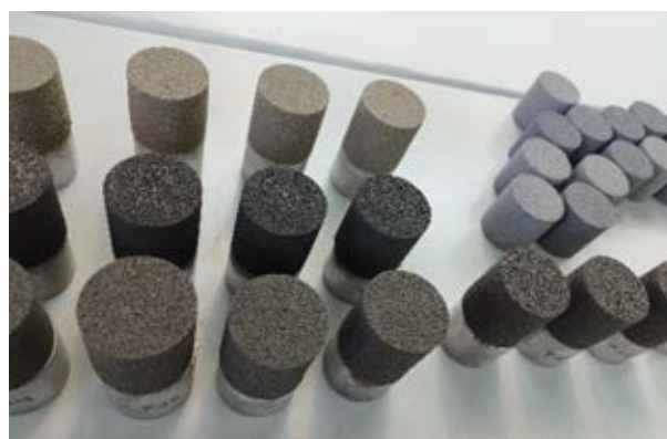
Figura 2. Probetas 50x50mm basadas en distintas mezclas “arena-ligante” para el ensayo de rotura a compresión.
