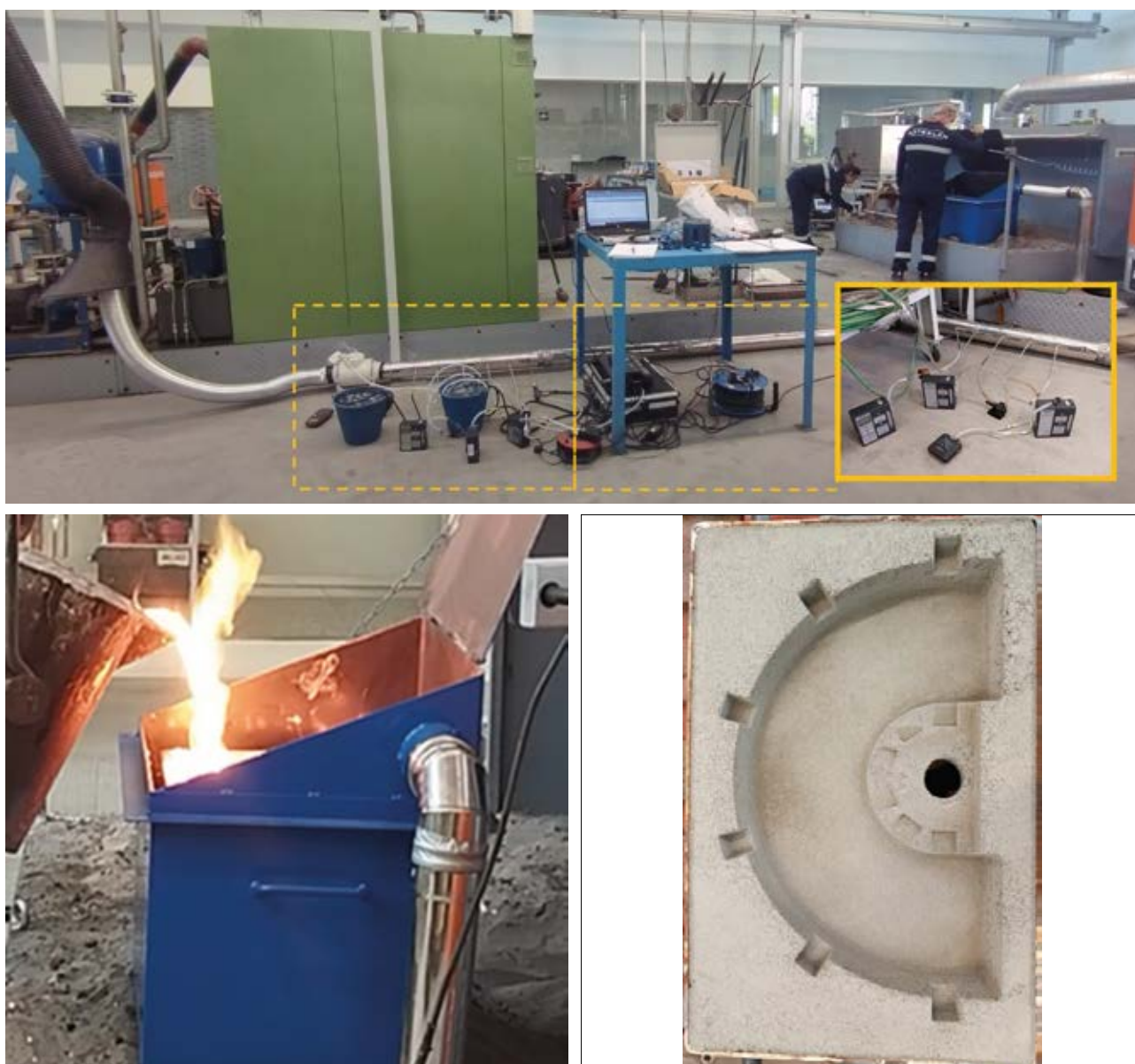
Figura 8. Procedimiento experimental en la Planta Piloto de Fundición de AZTERLAN y molde fabricado para la medición de emisiones.
