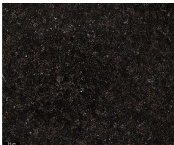
Figura 50: Acero 2343 en estado de temple, criogenia y revenido a 200°C (200x).
