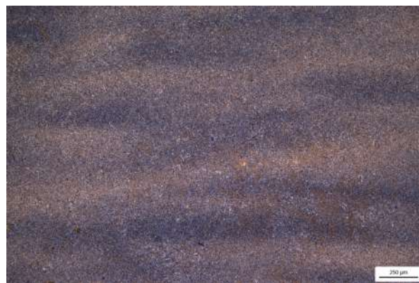
Figura 46: Acero 2343 recocido (50x).
