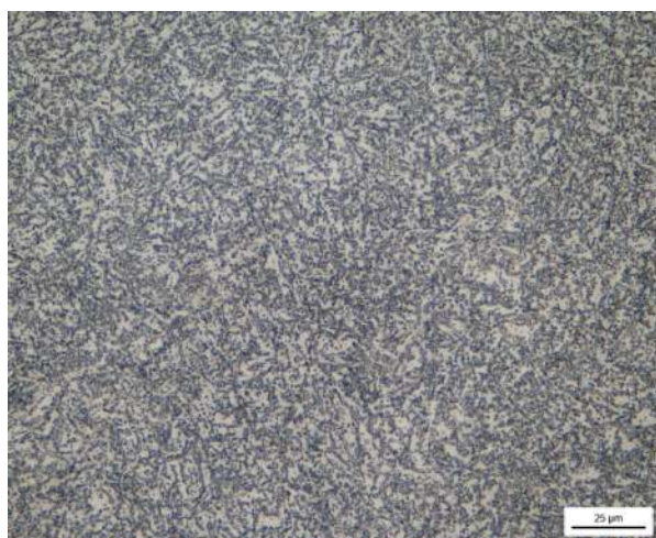
Figura 43: Acero 2367 recocido (500x).
