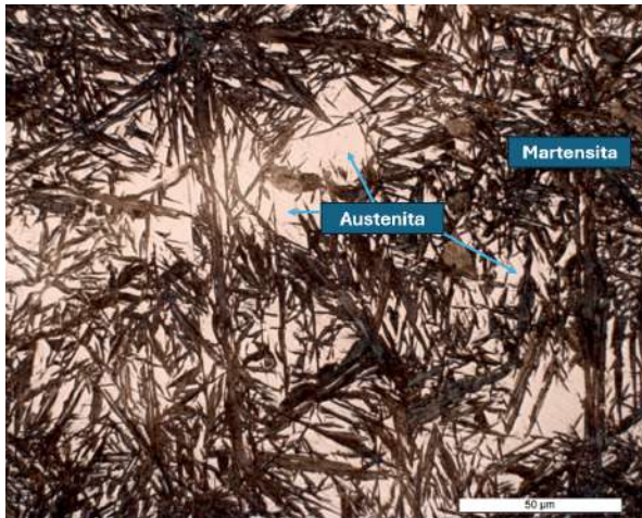
Figura 31: Imagen a 500x de acero hipereutectoide con martensita y austenita.
