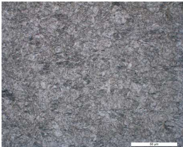
Figura 33: Imagen a 500x de acero hipoeutectoide en estado de temple.
