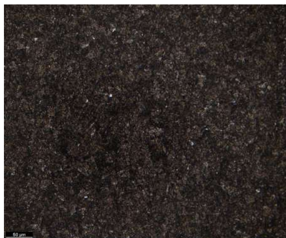
Figura 48: Acero 2367 en estado de temple, criogenia y revenido a 200°C (200x).
