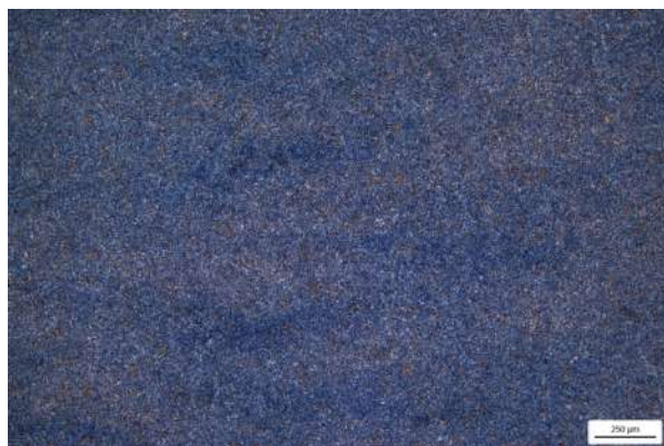
Figura 45: Acero 2367 recocido (50x).
