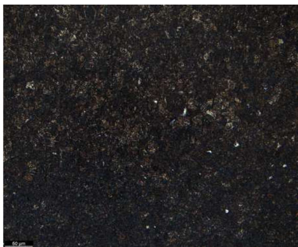
Figura 47: Acero 2367 en estado de temple y revenido a 200°C (200x).
