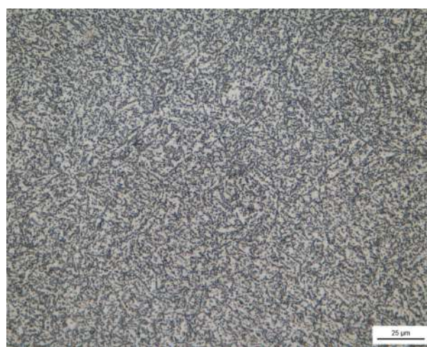
Figura 44: Acero 2343 recocido (500x).
