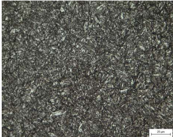
Figura 34: Imagen a 500x de acero hipoeutectoide templado y revenido.
