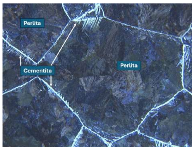
Figura 30: Imagen a 200x de acero hipereutectoide con perlita y cementita.
