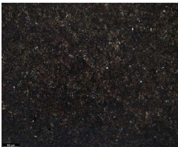
Figura 49: Acero 2343 en estado de temple y revenido a 200°C (200x).
